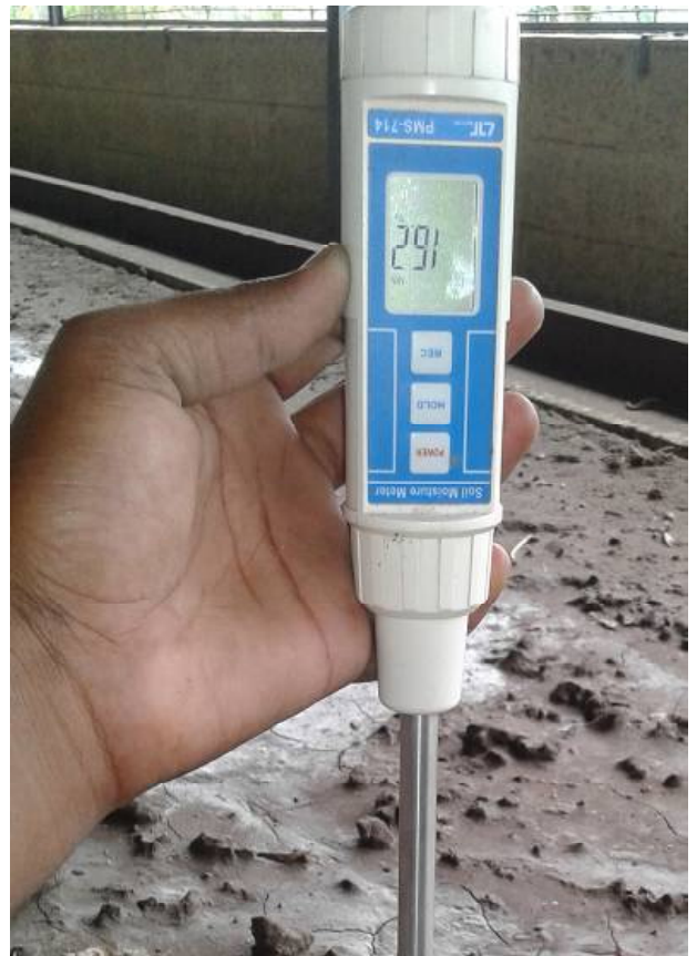
Fig. 3. Soil moisture meter
